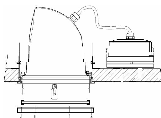
Fissare con le viti la base alla scatola (dove prevista ), inserire il corpo nell'anello precedentemente installato serrando le viti applicare lampadina con Watt non superiori a quanto indicato in etichetta, accendere l'apparecchio e farlo funzionare in queste condizioni per almeno 2 / 3 ore. (Assicurarsi che vi siano i requisiti minimi di sicurezza). Ad apparecchio freddo procedere all'applicazione del vetro fissando l'anello in alluminio al corpo con le viti.(max 3,6 Newton/metro)
