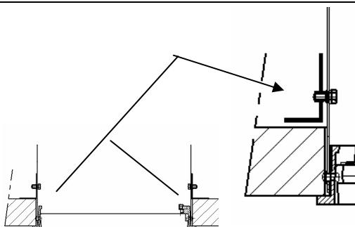
Applicare l'anello comprensivo di staffe di sostegno come indicato in figura e bloccare accuratamente le viti dopo aver posizionato le piastrine piegate ad "L"
