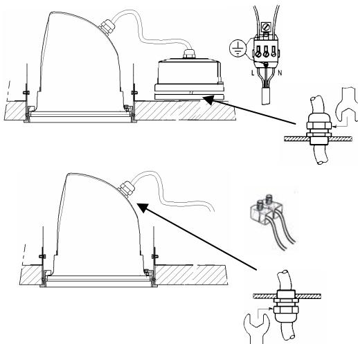
Inserire il cavo di alimentazione nel pressacavo e bloccare la ghiera max 5/7 Nm . Collegare il cavo di alimentazione in morsettiera o nei morsetti (dove previsti) rispettando la connessione di terra. Utilizzare guaine in silicone in prossimità dei collegamenti elettrici.
