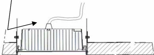
Inserire il cavo di alimentazione nel pressacavo. Collegare il cavo di alimentazione in morsettiera o nei morsetti (dove previsti) rispettando la connessione di terra. Utilizzare guaine in silicone in prossimità dei collegamenti elettrici.
