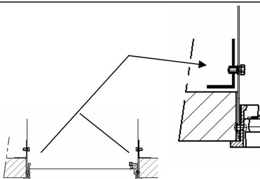
Applicare l'anello comprensivo di staffe di sostegno come indicato in figura e bloccare accuratamente le viti dopo aver posizionato le piastrelle piegate ad "L"
