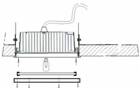
Inserire il corpo nell'anello precedentemente installato serrando le viti applicare lampadina con Watt non superiori a quanto indicato in etichetta, accendere l'apparecchio e farlo funzionare in queste condizioni per almeno 2 / 3 ore. (Assicurarsi che vi siano i requisiti minimi di sicurezza). Ad apparecchio freddo procedere all'applicazione del vetro fissando l'anello in alluminio al corpo con le viti.(max 2 Newton/metro)
